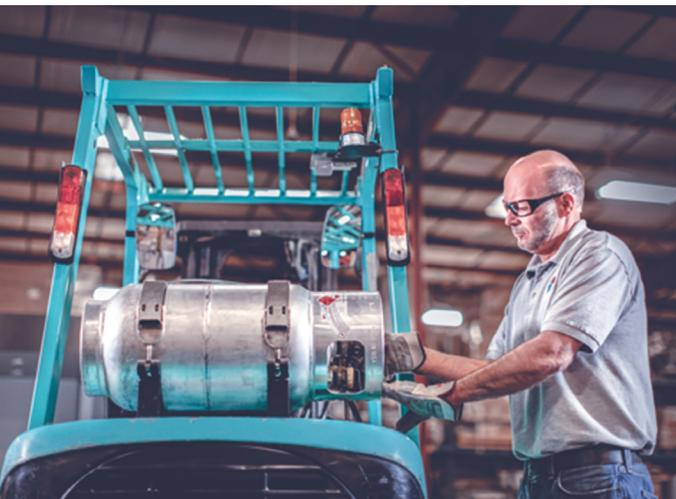
Les chariots élévateurs au propane peuvent être utilisés tant à l'intérieur qu'à l'extérieur.
